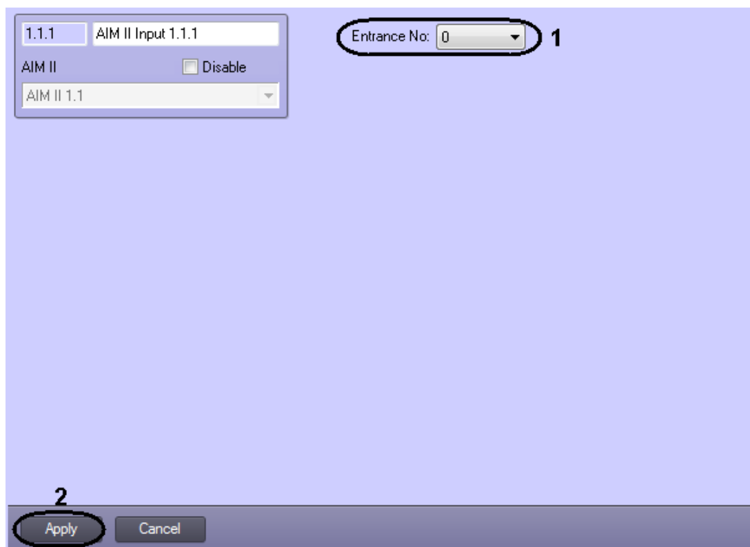
Fig. 3.7—2 Configure alarm input
