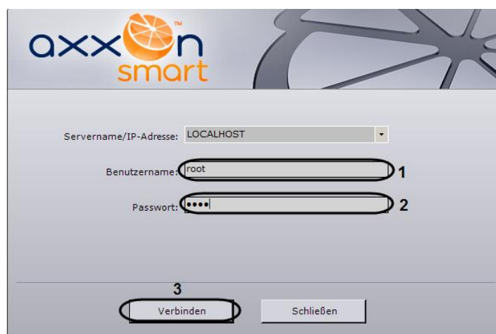
Abb. 5.1—1 Eingabe von Benutzernamen und Passwort für den Start der Softwareplattform Axxon Smart
