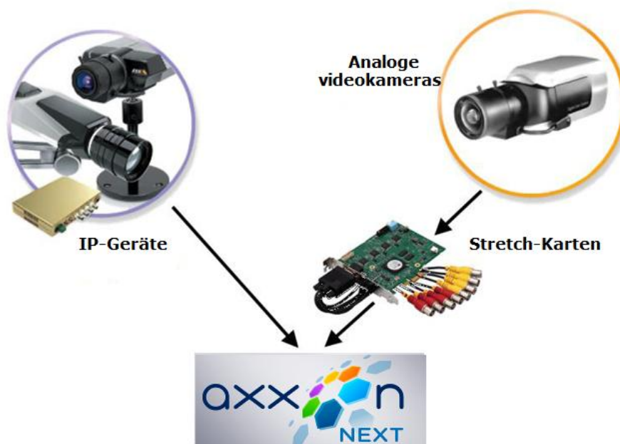
Abb. 1-1 Hybrides Sicherheitssystem auf Basis der Softwareplattform Axxon Next
